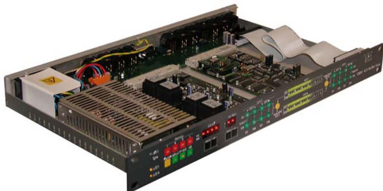
Fig.3 Shuffler-Baugruppenträger / Shuffler Card Cage
